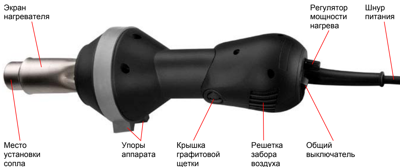
Рис. 1 Органы управления аппарата QUICK-S Electronic
