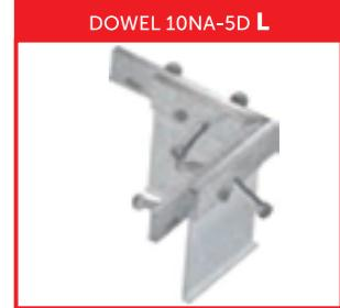
Несъемная опалубка VIVALJOINT DOWEL равномерно переносит нагрузки, благодаря чему, обеспечивает компенсацию и правильное взаимное перемещение всех сегментов бетонного пола относительно друг друга. Профиль для промышленного профиля VIVALJOINT DOWEL компенсирует перемещение плит до +30 мм перпендикулярно и до +15 мм параллельно относительно несъемной опалубки. Профиль VIVALJOINT DOWEL разработан с учетом требований переноса высоких нагрузок
