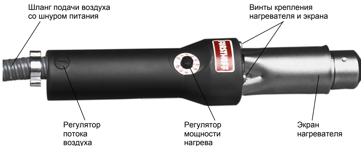
Рис. 1 Органы управления аппарата MINI Electronic
